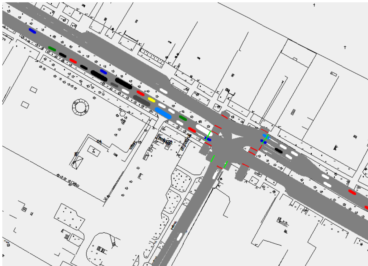
Rys. 32. Obraz ruchu na skrzyżowaniu ul. Sikorskiego z ul. Wyszyńskiego – liczba pojazdów oczekujących na jazdę na wprost wzdłuż ul. Sikorskiego w chwili włączenia sygnалу zielonego dla tego kierunku.
